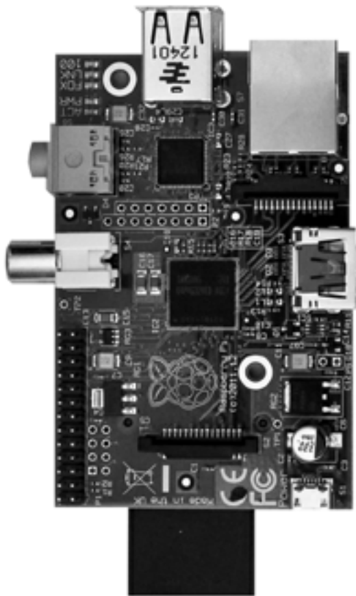
Le Raspberry Pi, ordinateur libre et minuscule, ici à l'échelle 1/1
